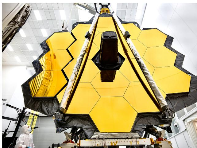
**Figure 3.** Lo specchio principale del telescopio spaziale di prossima generazione, il James Webb Space Telescope. Ciascuno dei 18 segmenti esagonali ha un diametro di circa 1.32 metri, per un diametro totale dello specchio pari a 6.5 metri.
