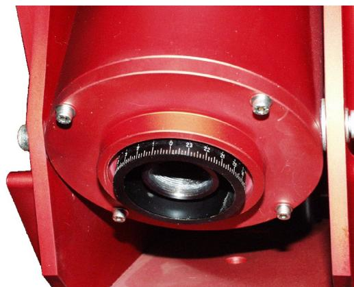
Fig. 4.22: La flangia montata con l'anello.
