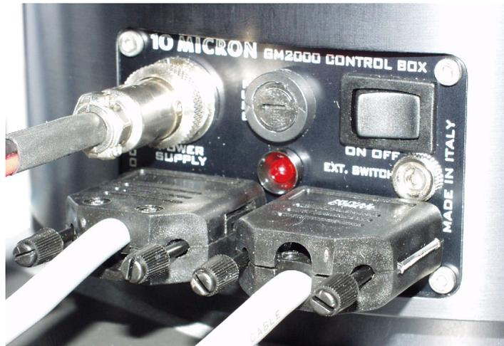
Fig. 5.12: Connessione dei cavi dei motori e di alimentazione.
