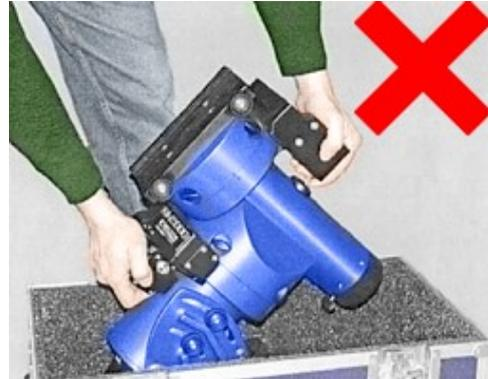
Fig. 4.7: Non sollevare la montatura così!
