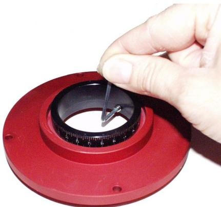
Fig. 4.21: Fissaggio dell'anello alla flangia.
