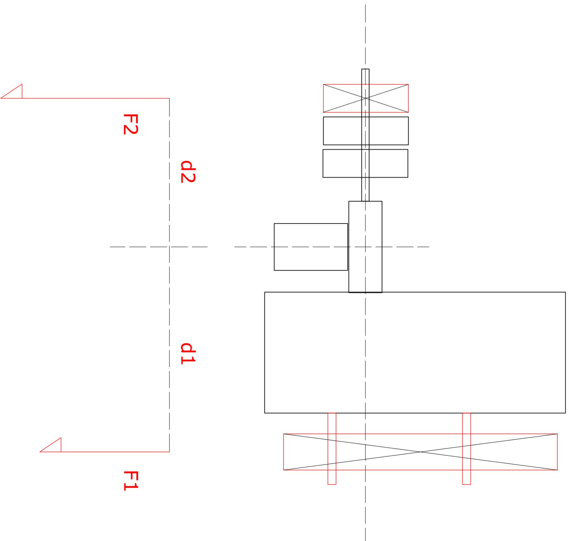
PARTENDO DAL PRESUPPOSTO CHE LA CONFIGURAZIONE INIZIALE DEL TELESCOPIO SIA IN EQUILIBRIO, SE SI AGGIUNGE UN PESO  $F1$  DATO DALL'AUSILIARIO + CCD DI GUIDA POSTI AD UNA DISTANZA  $d1$  DALL'ASSE DI ROTAZIONE, ALLORA OCCORRERA' BILANCIARE CON UN PESO  $F2$  DA PORRE AD UNA DISTANZA  $d2$  DAL MEDESIMO ASSE PARI A:
